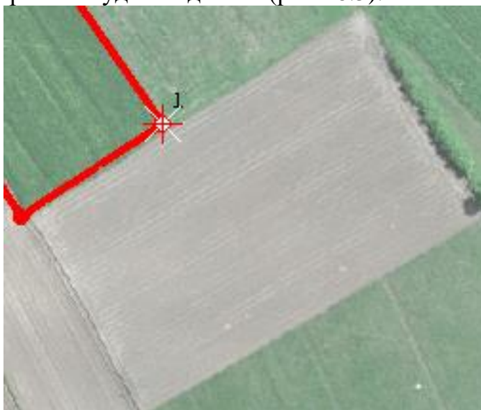
Рис. 16.5. Установка маркера во вторую точку замыкания
